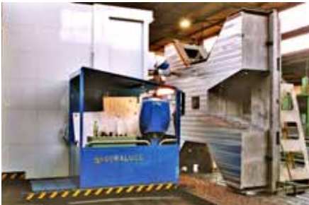
Fahrständer-Fräs- und Bohrcenter SORALUCE FS 8000 mit CNC-Bahnsteuerung Heidenhain TNC 530
