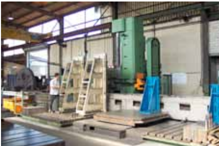
Plattenbohrwerk TOS WPD 130 Q mit CNC-Bahnsteuerung Heidenhain TNC 430 mit Tisch und Aufspannfeld
