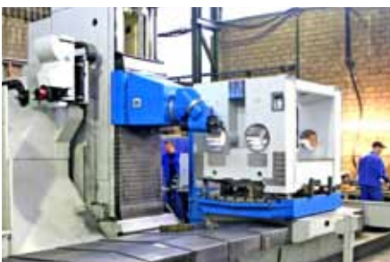
2 x Fräs- und Bohrcenter ANAYAK VH Plus 3000 MG 10 mit CNC-Bahnsteuerung Heidenhain TNC 530
