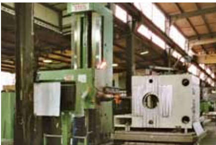
2 x Tischbohrwerk TOS WHQ 13 CNC mit CNC-Bahnsteuerung Heidenhain TNC 415
